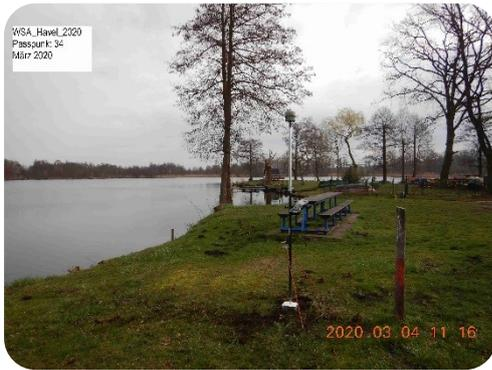
Signalisierung eines Passpunkts
