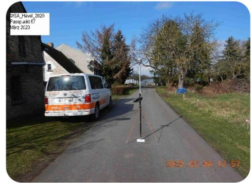
Abb. 2 Die Messung der Passpunkte erfolgte mittels dGPS
